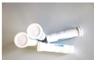
Diosol-Teststäbchen als Beweis der Lückenlosigkeit der Vernebelung
